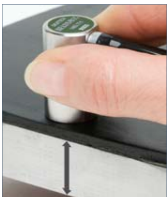
Messung auch durch die Beschichtung
